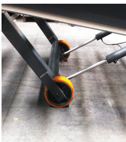
Roues de translation et vérins de levage
