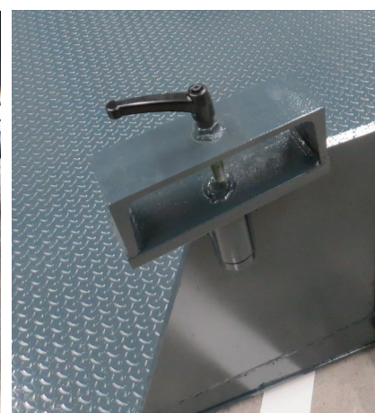
Anneau de fixation de la fourche du chariot élévateur pour déplacer la rampe
