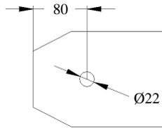
Le chariot élévateur a besoin d'un foret Ø22 dans l'une de ses fourches pour déplacer la rampe
