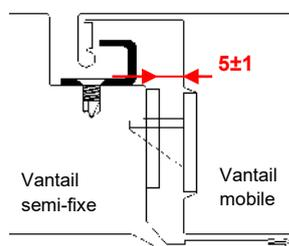
**9.3.** - Pour les portes coupe-feu à 2 vantaux, il est nécessaire de respecter le jeu entre la ligne "J" sur le vantail semi-fixe et le vantail mobile.
