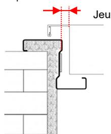
**9.2.** - Pour les portes coupe-feu à 2 vantaux, il est nécessaire de respecter la valeur du jeu de fonctionnement entre vantaux conformément au document de classement.
