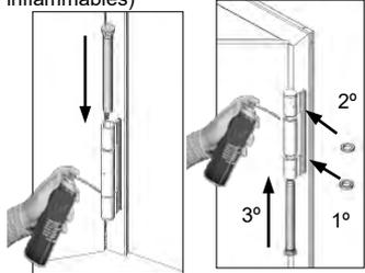
**6.2.** - Sur les portes coupe-feu, si le ferme-porte n'est PAS monté, il faut charger le ressort sur la tige de la charnière à fermeture automatique en utilisant le matériel fourni dans la boîte de la poignée de la porte ; si le ferme-porte est monté, ce réglage n'est pas nécessaire.
