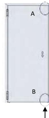
**10.1.- Zone supérieure.** Visser une vis à tôle M 4,8 x 16 FST dans le trou prédisposé marqué à l'étape précédente. Vissez doucement, en laissant un espace de 1 mm entre la lame et la tête de la vis.
