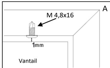
**10.2.- Zone inférieure.** Vis M5x50 et bouchon plastique M8x40 qui doivent se trouver dans la zone côté serrure et ne pas intervenir dans la zone de libre passage pour être utilisés comme une porte, en laissant un espace de 1 mm entre le vantail et la tête de la vis. L'emplacement de cette vis sera à une distance de 15 x 15 mm du cadre (Image 1).
