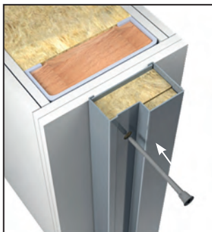
2. Pour fixer le cadre au plaques de plâtre, insérez les vis appropriées, en passant par le trou prévu dans le cadre et le trou de la plaque de fixation jusqu'à ce qu'elle soit ancrée dans le mur.
